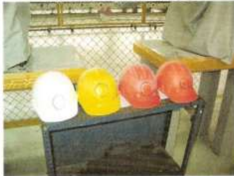
FOTO 1; No presentó flama visible después del tiempo de prueba.
