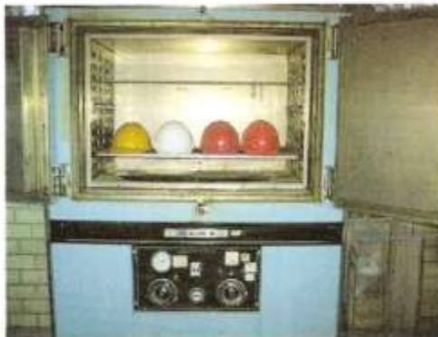
FOTO 3; Etapa de acondicionamiento en horno para la prueba de impacto.
