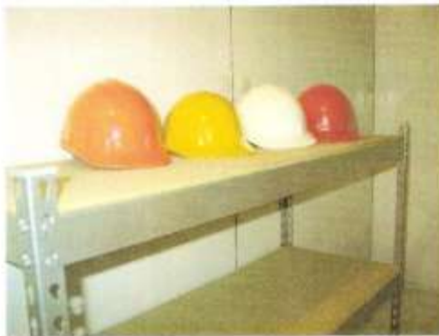
FOTO 2; Etapa de acondicionamiento en frío para la prueba de impacto.
